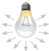
Der Lichtstrom bezeichnet die von einer Lichtquelle gesamte Strahlungsleistung, unabhängig von der Ausstrahlrichtung. Er wird in der Einheit Lumen angegeben.
