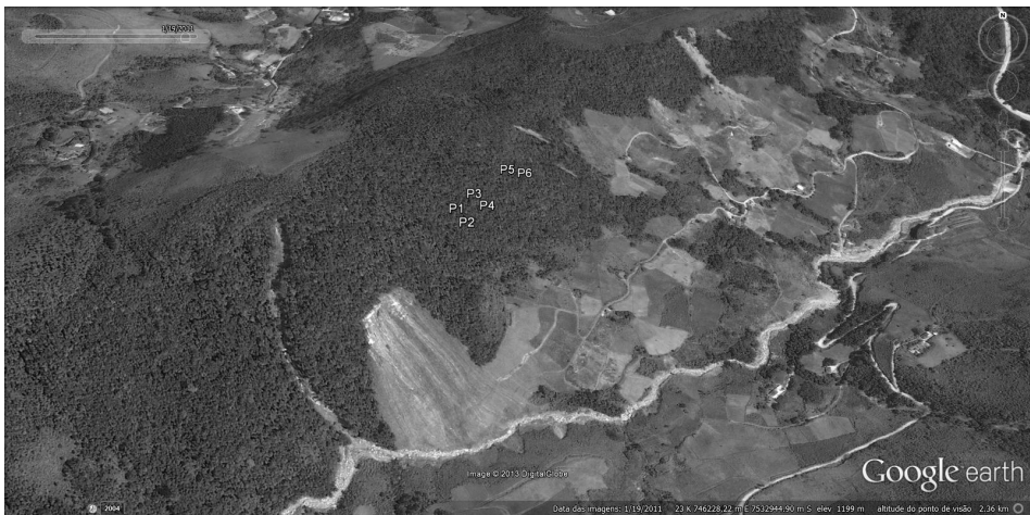
Figura 1. Localização das parcelas na área #1 – Floresta de aprox. 50 anos. Na porção central esquerda um deslizamento no contato solo-rocha, de 2011. Google Earth, imagem de 19/01/2011. Município de Nova Friburgo, Rio de Janeiro.
