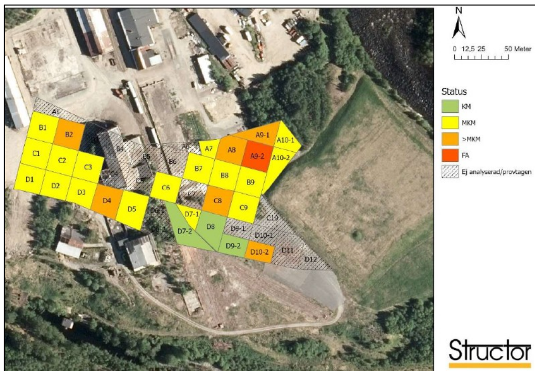
Figur 13. Utdrag av Structors analysresultat från provtagning 2022. Provrutornas status baserad på maximal halt av metaller i respektive provruta. Orange rutor visar halter över MKM och under FA och röda rutor visar halter över FA (Structor, 2022a).
