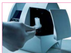
Kartusche im Analyzer platzieren Anzeige in ca. 3:50 Minuten
