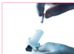
Blutkollektor in die Quo-Test Kartusche einfügen
