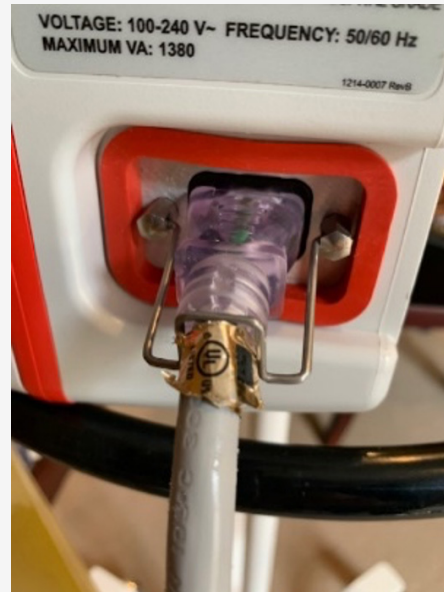
Figura 1: Enchufe de tres clavijas con conexión a tierra que se mantiene en su lugar con un pestillo de seguridad para prevenir la desconexión accidental del cable de electricidad.
