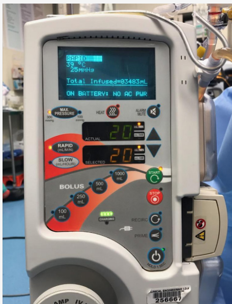
Figura 2: Después de desconectar el infusor rápido, la pantalla deja de mostrar “HEAT ON” (CALOR ENCENDIDO) y, en cambio, aclara “ON BATTERY: NO AC PWR” (A BATERÍA: SIN ELECTRICIDAD) con el aviso parpadeante “HEAT OFF” (CALOR APAGADO) (Nota: Las fotos se obtuvieron después de que ocurriera el evento clínico).
