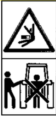
¡Al enganchar los dispositivos y accionar el sistema hidráulico, no debe haber nadie presente entre las máquinas!
