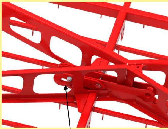
Figura 10: Chapa de bloqueo de plegado en el bastidor lateral
