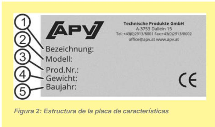
Figura 2: Estructura de la placa de características
