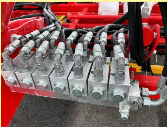
Figura 9: Divisor de flujo en el bastidor central
