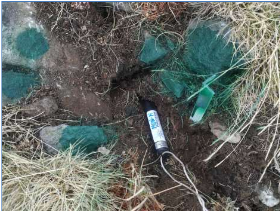
Instalación de un termómetro antes de enterrarlo
