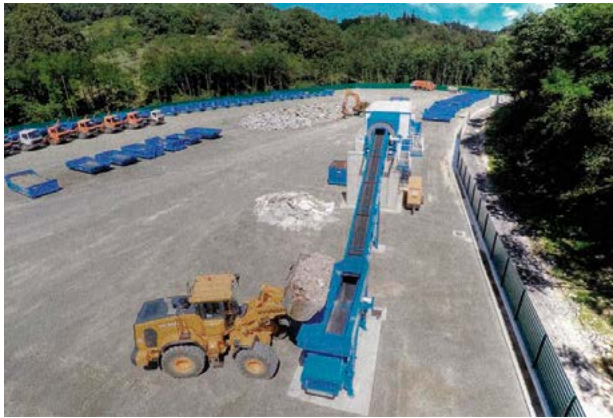
Figura 29. Cadena de tratamiento de residuos de construcción y demolición.
