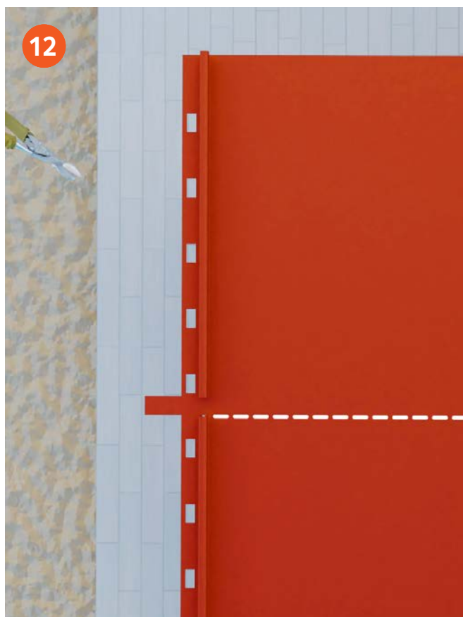
Vik ner urklippen på båda sidorna för att komma åt att kapa plåten.
