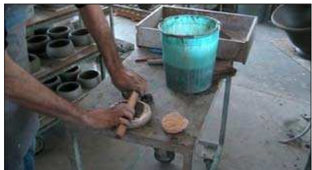
Fig. 6. La lisciatura a stecca eseguita dal ceramista Alessio Paci per la rimozione dell'argilla in eccesso da una matrice.
