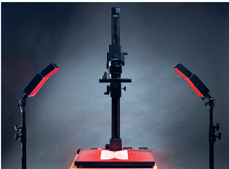
Abbildung 5: Versuchsstand mit gleichmäßiger Ausleuchtung, Farbfilter vor Kamera und Blitzlicht (Phase One A/S)
