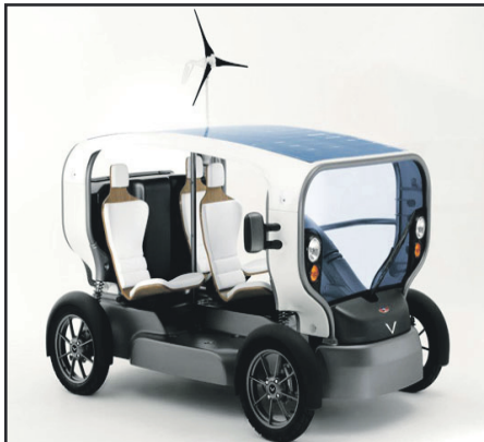
'Venturi Eclectic', un outo produsí pa e kompania di outo Frances 'Venturi'. E ta usa energia di bientu i solo i por si akaso falta energia, bo por recharge e ku koriente di WEB. Su top speed ta 50 km pa ora i e por kore 50 km promé ku mester recharge. E vehikulo aki ta perfekto pa islanan chikitu manera Boneiru.
