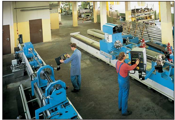
Tieflochbohr- und Honzentrum mit modernster Technologie.
