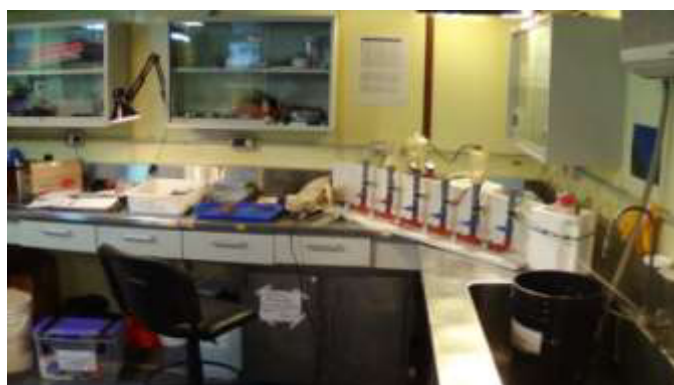
Figura 5.2. Espacio de laboratorio a bordo, sistema de filtración utilizado para filtración de las muestras de agua y plancton.
