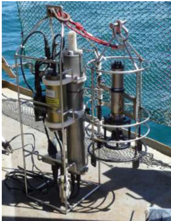
Figura 1.7 Disposición de los equipos SBE-19 (izquierda) y Rinko JFE ASTD-102 (derecha), amarrados por sus respectivas jaulas protectoras. En esta disposición y sincronizados (hora GMT) se realizaron todos los perfiles hidrográficos de la campaña.
