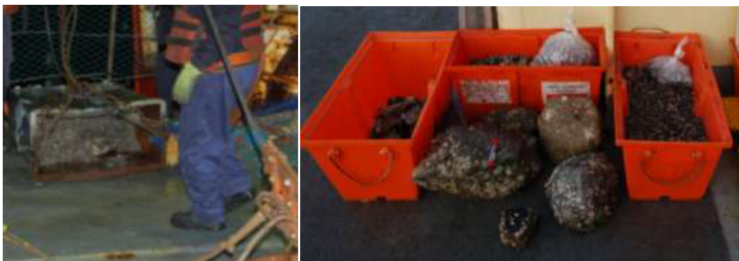
Figura 15. 2. Fotografías del material dragado de la estación E20. Dragas recuperada en la popa del BOPD (izquierda) y muestras recuperadas con la draga, separadas en cajas para su estiba (derecha).
