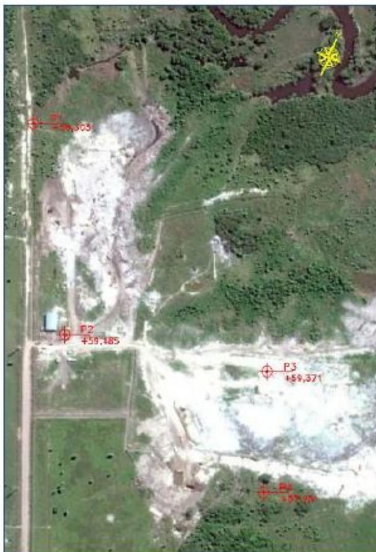
Posteriormente, se estudió el perfil estratigráfico de los suelos explorados, analizando sus características mecánicas y físicas (Tabla 7, Tabla 8, Tabla 9 y Tabla 10). La perforación en todos los casos llegó a los 7,60 m de profundidad; y según los datos analizados no se alcanzó el nivel freático; por tanto, se entiende que el mismo se encuentra por debajo de dicha profundidad.
