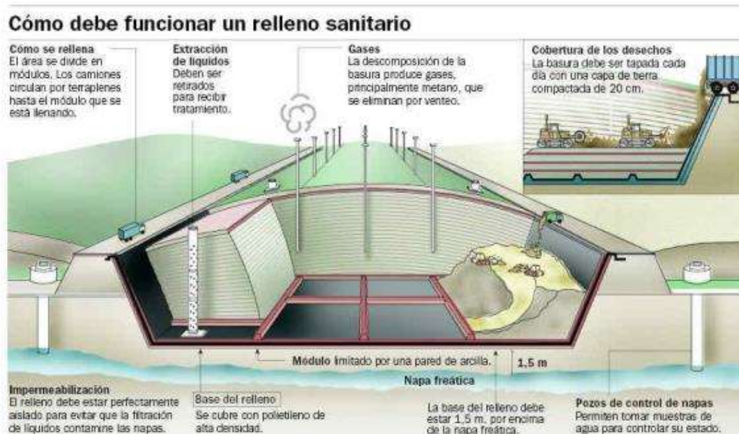
Figura 7-15. Funcionamiento de un Relleno Sanitario tradicional.
