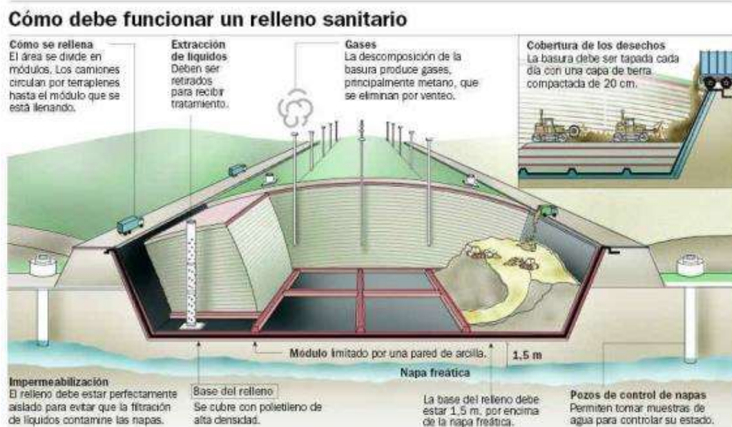
Figura 1-6 Esquema de funcionamiento de un Relleno Sanitario tradicional
