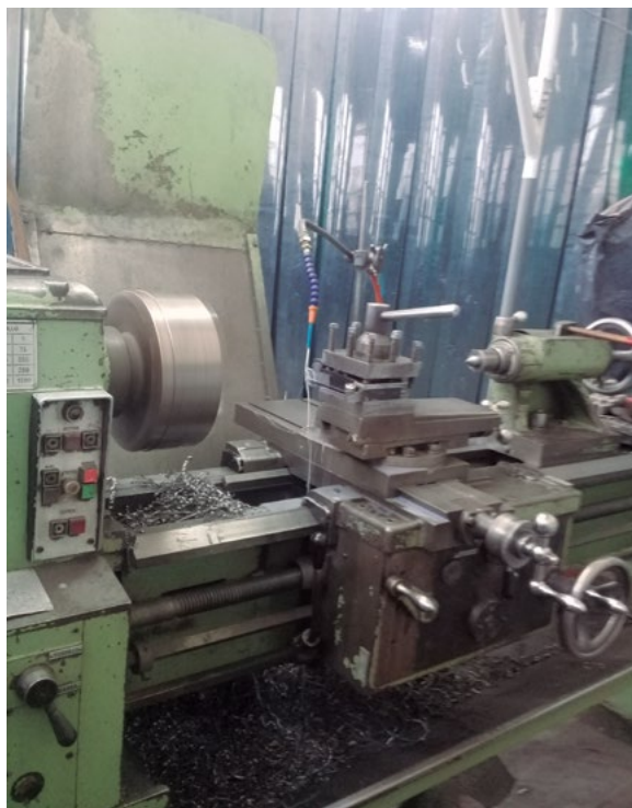
Imagen 6: generación de virutas en torneado. (Fuente: ADIMRA) lluvia. (Fuente: ADIMRA)
