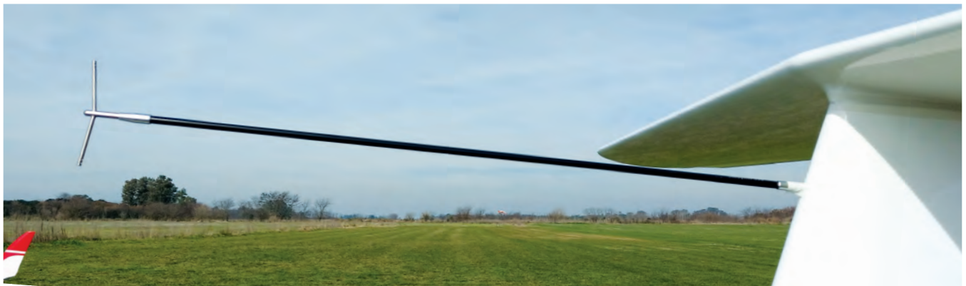
Figura 10. Sondas de energía total
