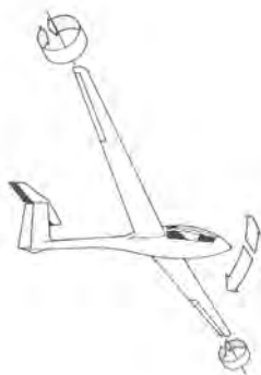
Eje de cabeceo (eje transversal)
