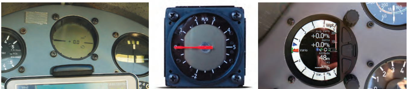
Figura 28. Distintos tipos de variómetros eléctricos
