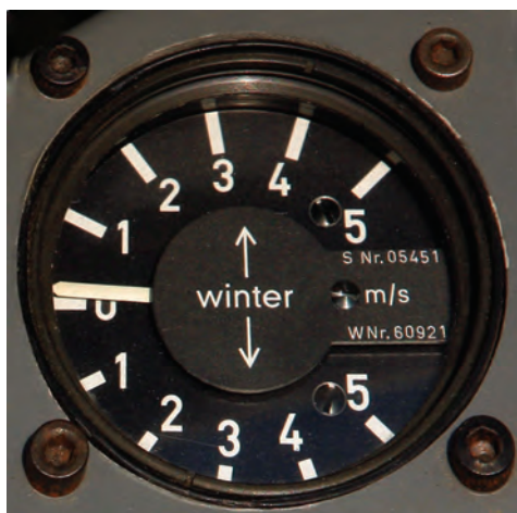
Figura 5. Variómetros de 5 m/s, 80 mm y 57 mm
