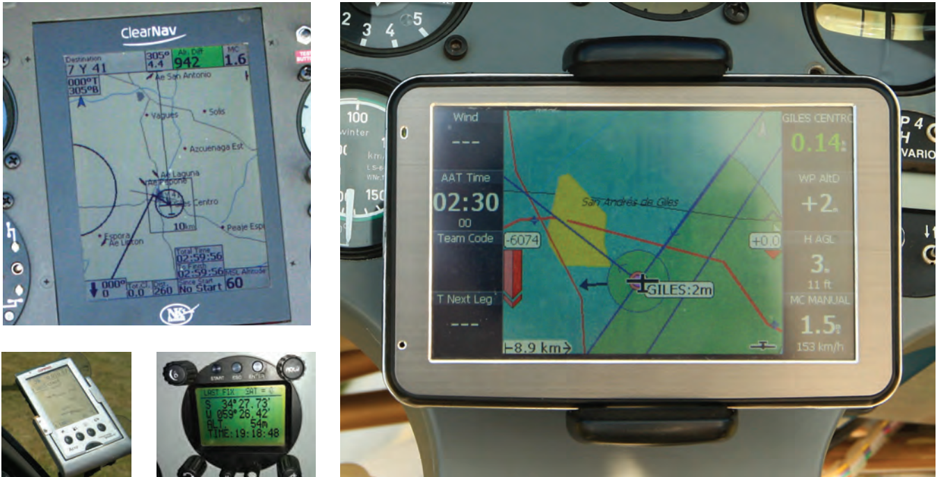
Figura 35. Display y pantallas de navegación
