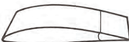
Velocidad media, máxima L/D flap neutro
