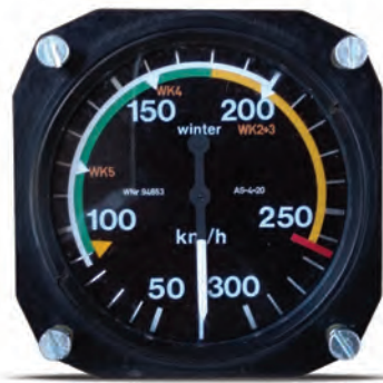
Figura 3. Velocímetros en km/h de 80 mm y 57 mm
