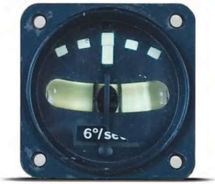
Figura 16. Giro y ladeo clásico
