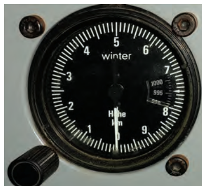
Figura 1. Altímetros en metros, dimensiones 80 mm y 57 mm
