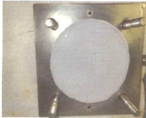
Clean RO membrane
