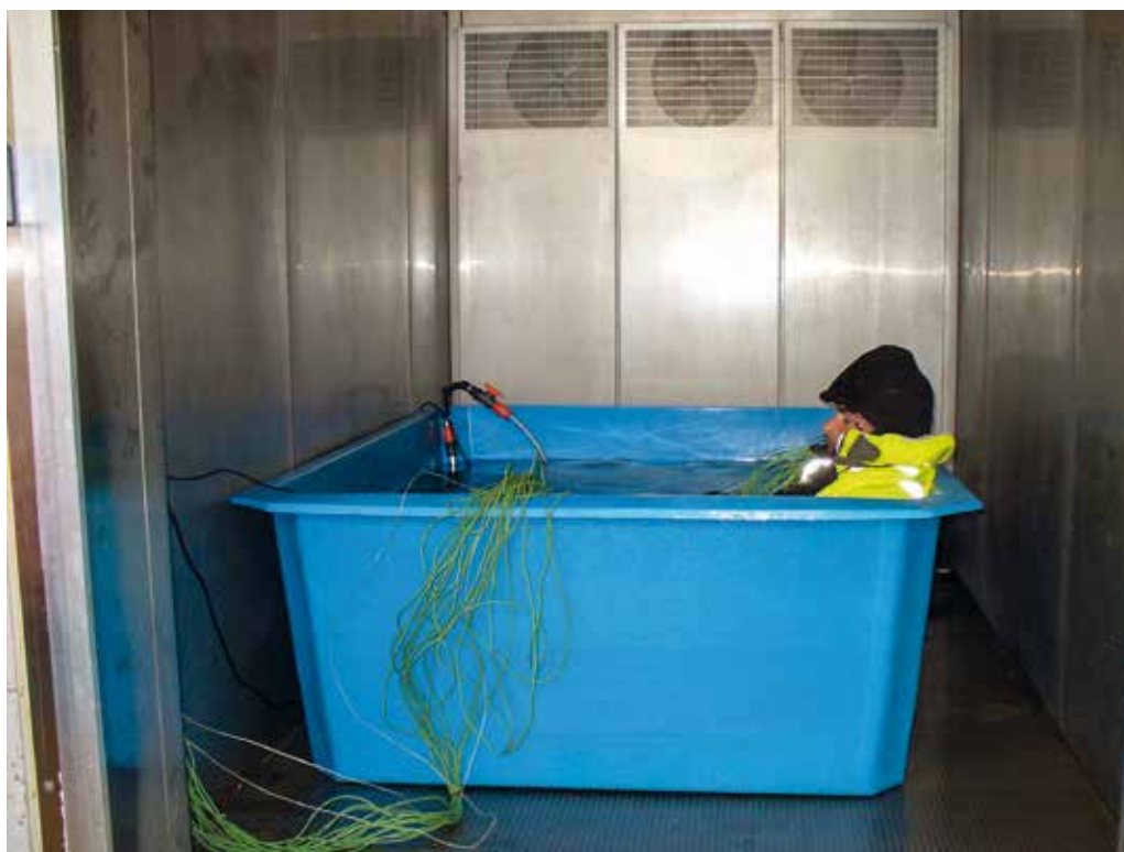
Při zkoušce tepelné ochrany obleku nesmí dobrovolníci ve vodě poklesnout teplota o více než dva stupně.
