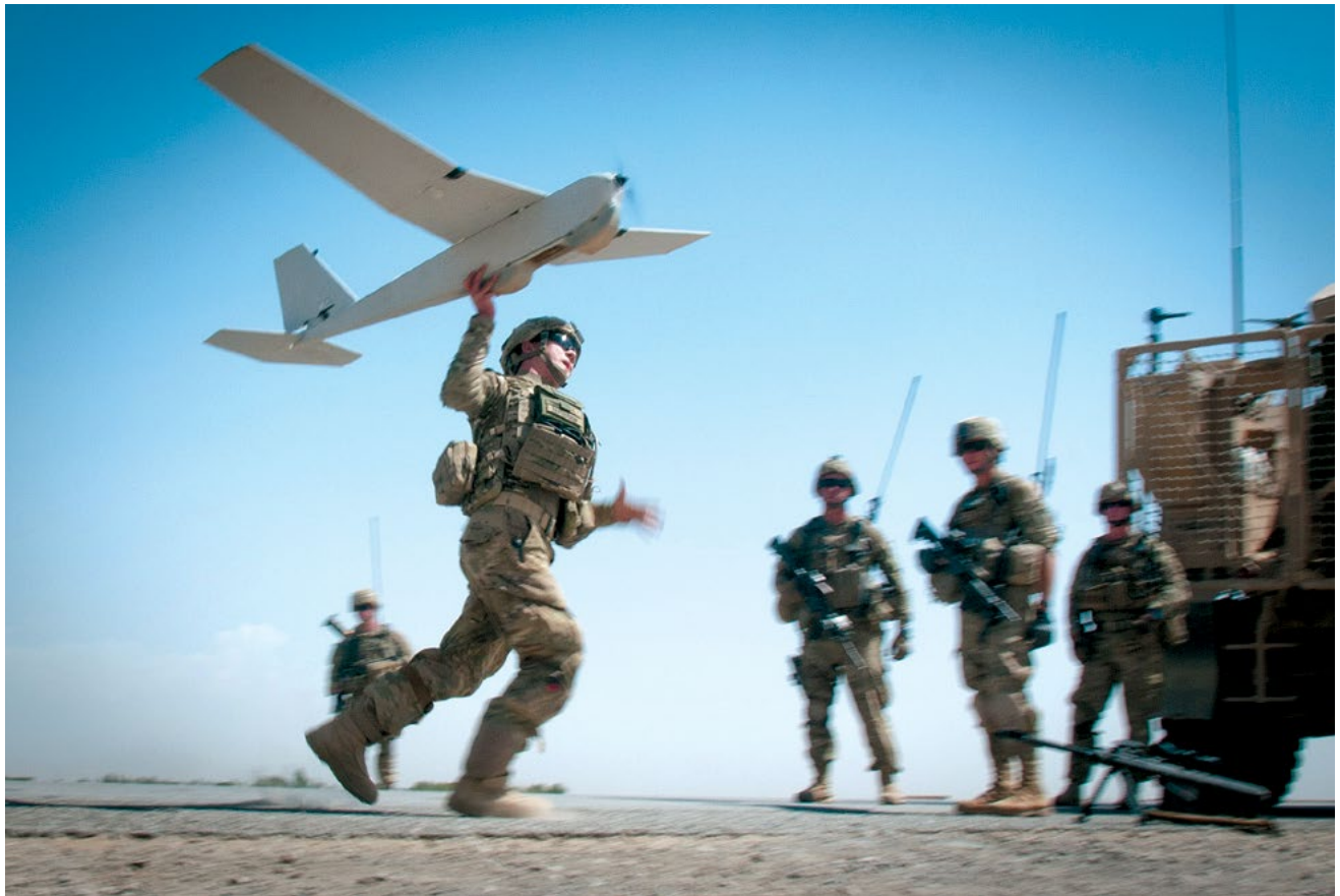
Oficial Técnico 2ª Clase Dylan Ferguson, un oficial del elemento de aviación del 1º Equipo de Combate de la 82ª División Aerotransportada lanza un vehículo aéreo no tripulado tipo Puma, 25 de junio de 2012, en la provincia de Ghazni, Afganistán. Ferguson usa el vehículo Puma para llevar a cabo el reconocimiento aéreo en apoyo de tropas en el terreno. (Foto: Ejército de EUA, Sgto. Mike MacLeod)
