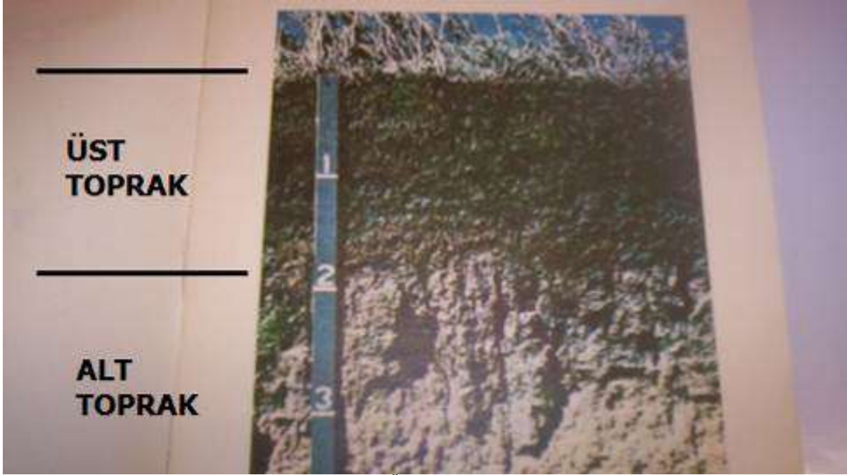
Şekil III.2.19.58. Peyzaj Onarım Çalışmalarında, Üst Toprak Katmanı
