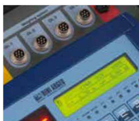
LCD-ANZEIGE MIT HINTERBELEUCHTUNG Für die Visualisierung von dem Gewicht jeder Plattform und von dem Schwerpunkt.
