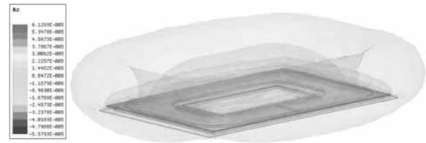
Abbildung 2: B_z -Feldverteilung in der zirkulären Spule
