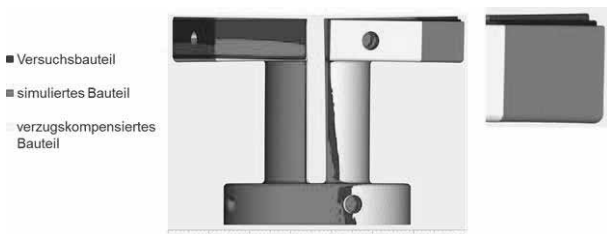
Abb. 8: Simulations- und Kompensationsergebnis [3]
