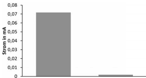
Abbildung 9: Ableitstrom des Grundsystems ohne (links) und mit (rechts) geteiltem Zwischenkreis
