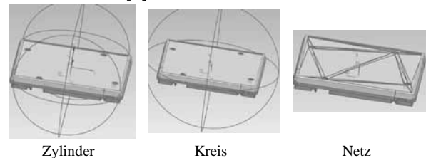
Abbildung 5: drei mögliche Kollisionskörper am Werkstückträgermodell
