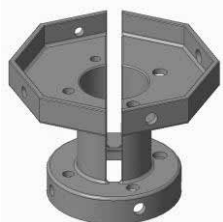
Abb. 4: Versuchsbauteil für die Validierung der Simulationssoftware
