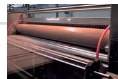
Water cooled Splitrods / Wassergekühlte Trennstäbe
