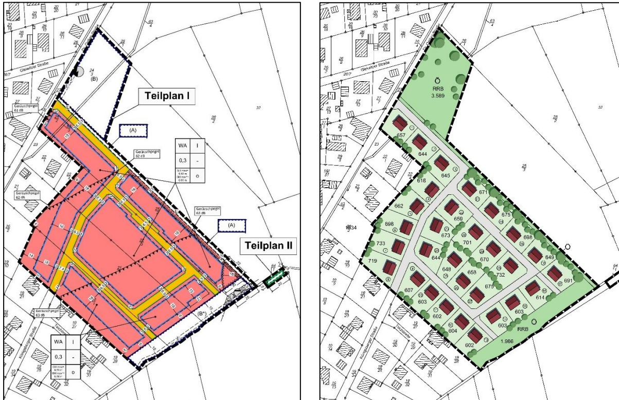
Abb. 13: Auszug aus dem Bebauungsplan Nr. 13 „Teichbreite“ und nebst. städtebaulicher Entwurf, Ortsteil Rehren
