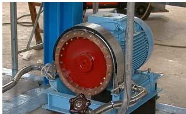
3.att. EM indukcijas sūkņu ar pastāvīgiem rotējošiem magnētiem modelis. (Autors: foto)
