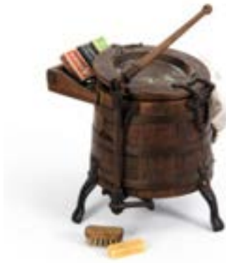
156 Limit € 180 „Schaede's Schnell-Waschmaschine“. M. Schaede, Saalfeld. Um 1910. Holz, Metall. H 23 cm. Seltene frühe Waschmaschine in Zuberform, geböttchert, mit Metallteilen, innen Quirl (über äußeren Hebel beweglich). Leichte Altersspuren.
