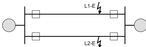
Bild 2-4 Mehrfachfehler auf einer Doppelleitung
