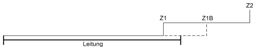
Reichweite nach 1. Wiedereinschaltung (Übergreifzone Z1B gesperrt)
