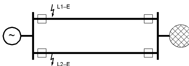
Bild 2-6 Generatornaher Mehrfachfehler auf einer Doppelleitung
