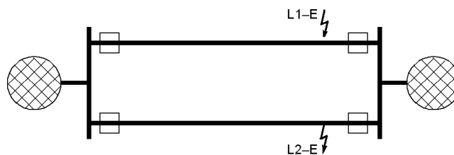
Bild 2-5 Mehrfachfehler auf einer Doppelleitung
