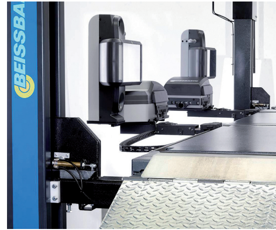
Mit Hilfe von Smart-Link-Adaptern können die Messwertaufnehmer stufenlos längs und quer verstellt werden
