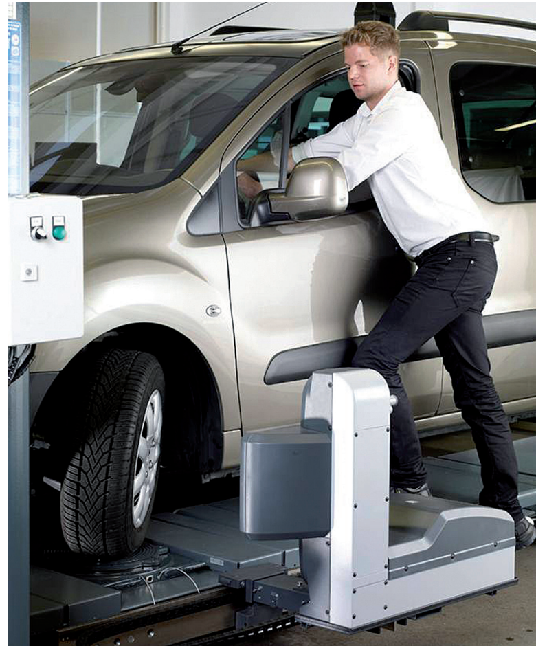
Bei der Lenkroutine werden die Räder jeweils bis 20 Grad zu beiden Seiten eingelenkt
