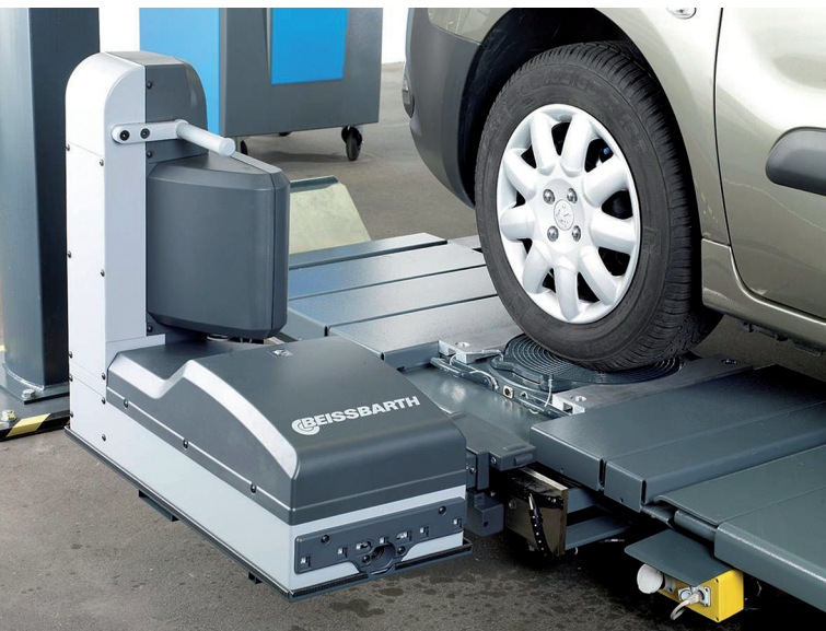
Sobald die Räder einige cm nach vorne verschoben wurden, liegen die Messwerte vor
