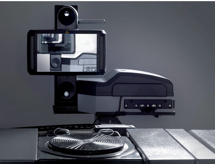
Hinter dem Spiegel des Messwertaufnehmers befindet sich ein Infrarot-Laserprojektor
