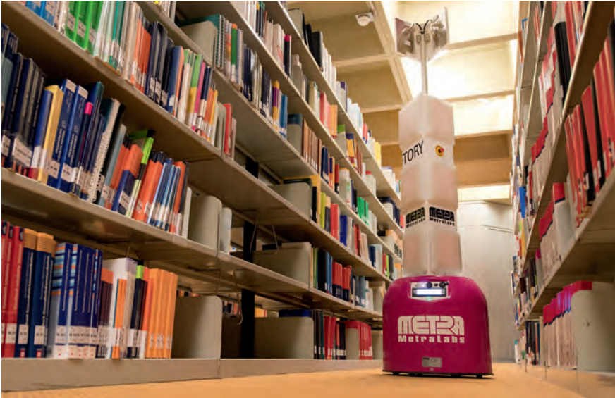
„Tory“ fährt eigenständig durch die Gänge der UB der TU Dortmund und scannt dabei die Medien. Foto: Martina Hengesbach/TU Dortmund
