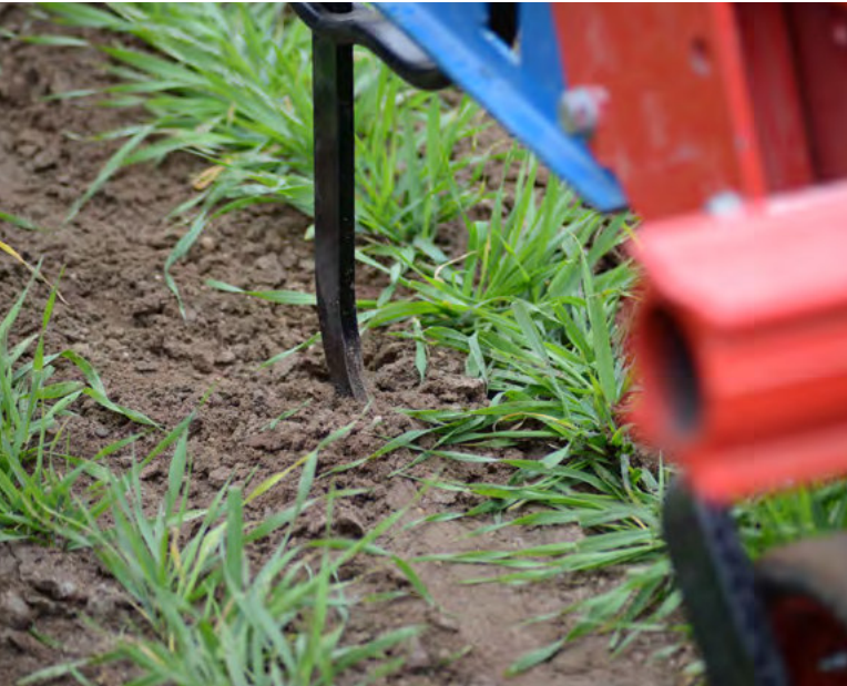
Sensorgesteuerter Hacke zur Unkrautbekämpfung in Getreide
