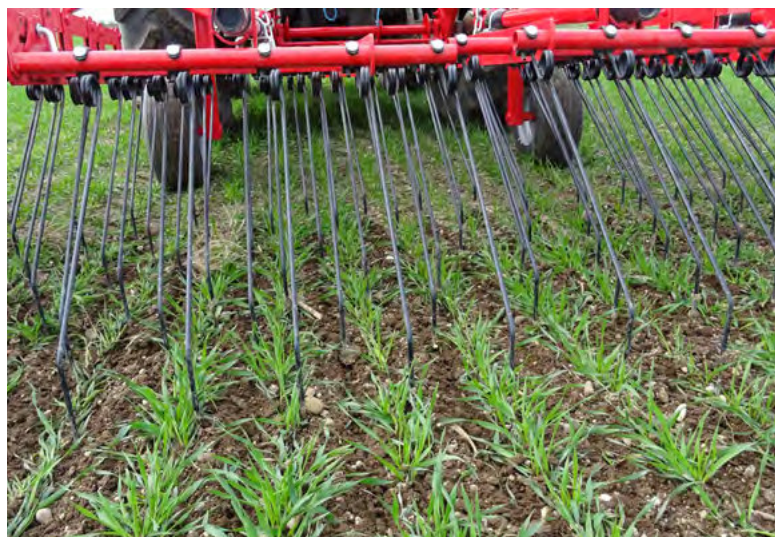
Mechanische Unkrautregulierung mit Striegel in Winterweizen
