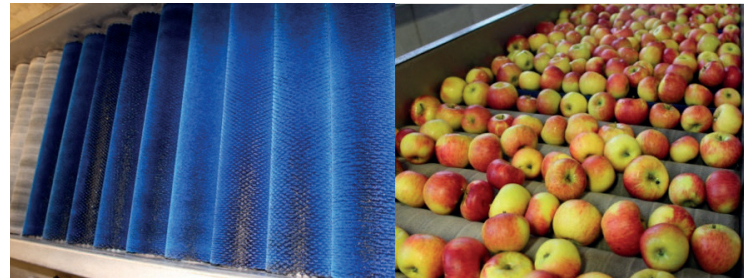
Bild 43: Abbürsten und Sortierung von Äpfeln (© Heinrich Blank)
