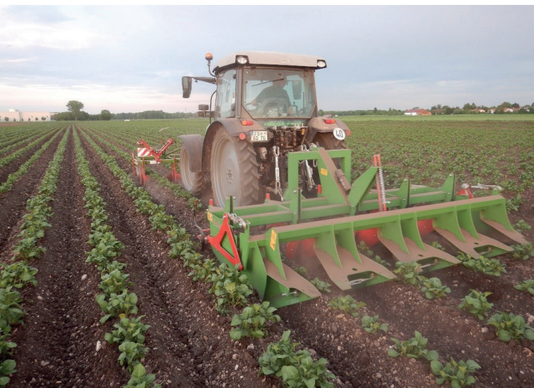
Bild 15: Häufelgerät in Kartoffelbestand in Kombination mit Fronthacke (© Christian Landzettel)
