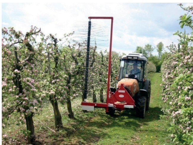
Bild 27: Ausdünnung mit Fadengerät (© Jürgen Zimmer)
