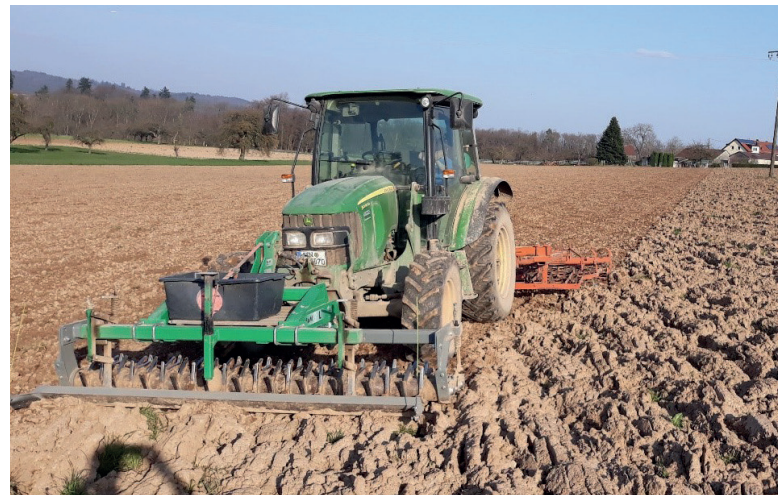
Bild 14: Anlage falsches Saatbett mit Frontpacker für Rückverfestigung und Einebnung sowie Zinkenegge hinten (© Jonathan Kern)
