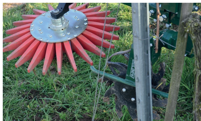
Bild 58: Fingerhacke in Kombination mit Rollhacke (© BÖW)
