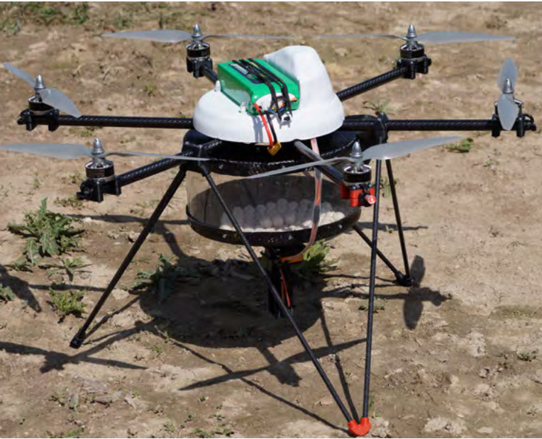
Multikopter zur Ausbringung von Trichogramma -Kugeln in Mais
