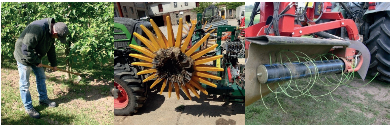
Bild 25: Eine "Bürste" am Gerät (Bild Mitte, © Jutta Kienzle) kann die Notwendigkeit für Handhacke (links, © Jürgen Zimmer) reduzieren. Rechts Fadenrotor (© Jürgen Zimmer).
