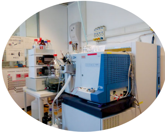
Das Gebäude der Rheinüberwachungsstation (RÜS) in Weil (links). Das hochauflösende Massenspektrometer (HPLC-HRMS), mit dem die Tages-Sammelproben analysiert werden (unten). Bilder: Beat Jordi (l), Steffen Ruppe
