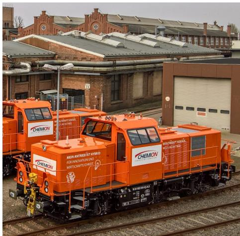
Photo d'une locomotive hybride H3 aux couleurs de Chemion sur le site Alstom de Stendal en Allemagne. À ce jour, 19 locomotives de ce type sont en circulation. En France, ce concept est encore absent.
