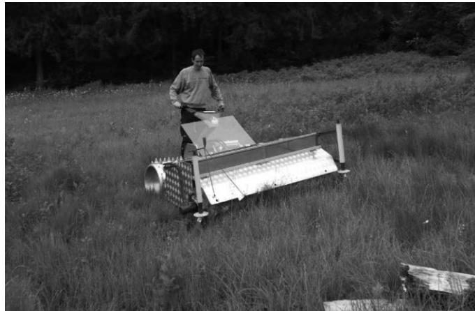
Peter-Max Zängerle mit dem selbst gebauten Wiesensamensammler als Anbaugerät für den Brielmaier
