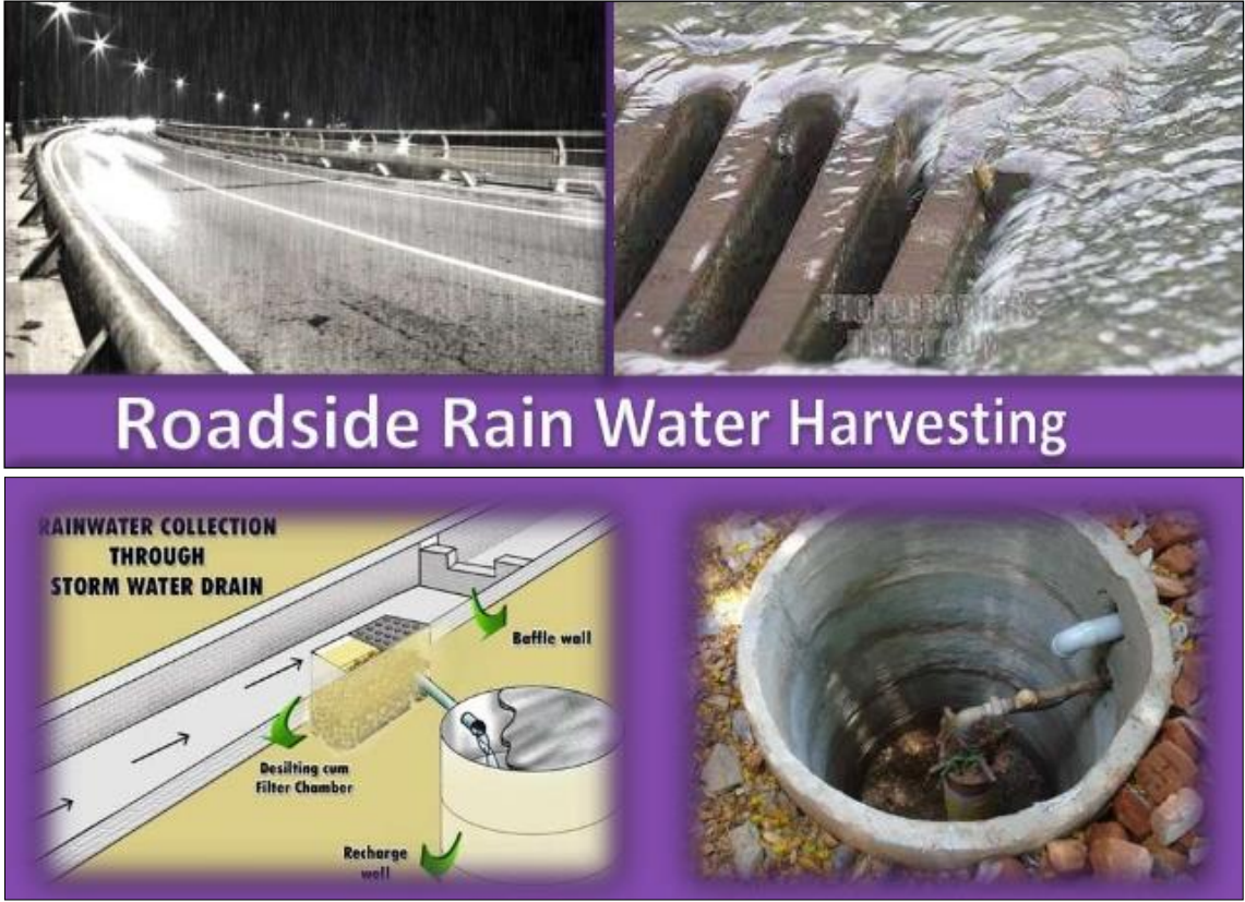
Şekil 15. Yol Kenarlarında Yağmur Sularının Depolanması
