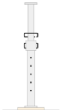
Puntello telescopico metallico con regolazione dell'altezza mediante manicotto filettato
