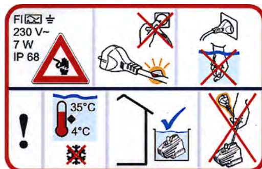
Bild 4: Sprachfreie Sicherheitshinweise für eine Teichpumpe (Quelle: Heissner AG). Erläuterungen im Text.
