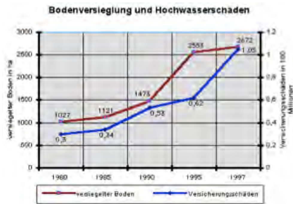
Bild 3: Das Diagramm hat einen klaren Bildtitel: Das Liniendiagramm zeigt den Zusammenhang zwischen Bodenversiegelung und Hochwasserschäden. Die linke Skala gibt den versiegelten Boden in Hektar an, die rechte Skala die Versicherungsschäden in 100 Millionen. Die beiden Linien haben einen annähernd parallelen Verlauf. Die beiden Skalen sind korrekt benannt und die Skaleneinteilung ist angetragen. Ein Gitternetz erleichtert das Ablesen von Werten, die zudem nah und gut lesbar an den Messpunkten angetragen sind.
