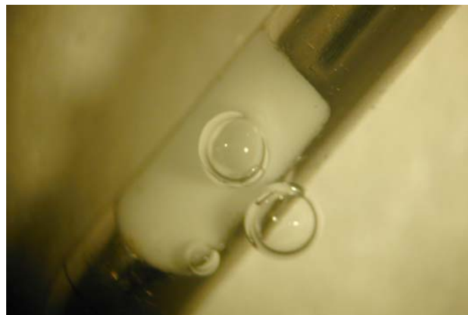
Abb. 3.47: Zerstörtes Silikon-Metall-Interface einer Drucknadel. Durch erzeugen eines Überdruckes in der Nadel treten am Rand des Silikons Luftblasen aus
