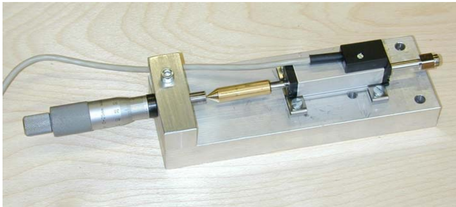
Abb. 3.36: Vorrichtung zur Kalibrierung des neuen Wegaufnehmers
