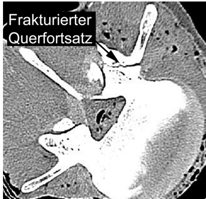
Abb. 3.3: CT Schnitt von LWS 18 mit Fraktur im Bereich der Facettengelenke, welcher zum Ausschluss des Präparates führte
