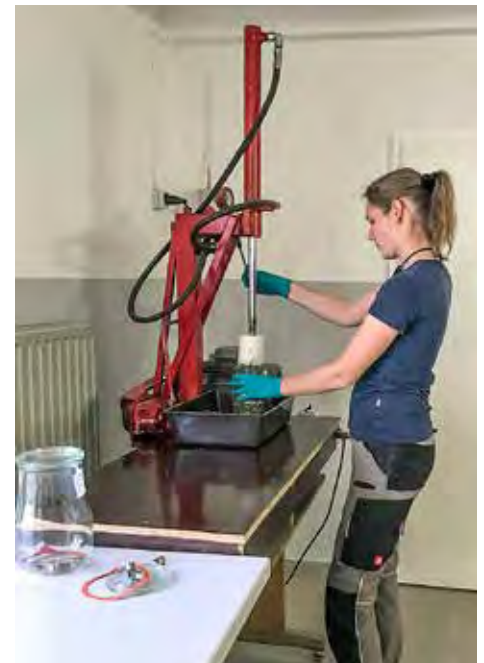
Zur Erzeugung der hoch verdichteten Silagen wird eine genau definierte Menge frischer Luzerne mithilfe eines maschinellen Stopfers in das Weckglas gepresst, seit 2021 in der frisch renovierten Versuchsstation Futterkonservierung.
