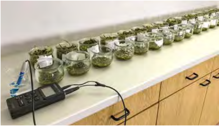
Zur Bestimmung der Ansäuerungsgeschwindigkeit erfolgt nach dreitägiger Lagerdauer die pH-Wert-Messung. Fotos (2): Dr. Susanne Ohl
