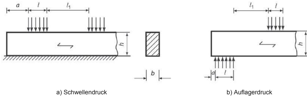
Bild 2.15 Belastungsanordnung mit Lasteinleitungslänge  $l$ , Zwischenabstand  $l_1$  und Querschnittsabmessungen bei Druck senkrecht zur Faser
