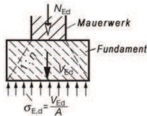
Bild 2.12 Flächenpressung bei einem Fundament
