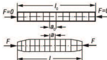
Bild 2.25 Die Querschnittsentfernung  $a_0$  im unbelasteten Zustand ist größer als die Querschnittsentfernung  $a$  im belasteten Zustand
