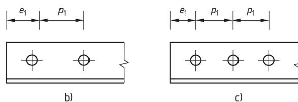
In zugbeanspruchten Querschnittsteilen muss eine vorhandene Querschnittsschwächung durch Löcher berücksichtigt werden. Als Bemessungswert der Zugbeanspruchbarkeit  $N_{t,Rd}$  ist dann der kleinere der beiden Werte  $N_{p1,Rd}$  bzw.  $N_{u,Rd}$  anzusetzen.
