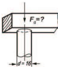
Bild 2.19 Rundholzstütze unter Deckenbalken
