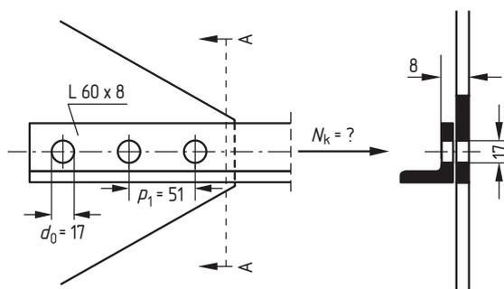
Bild 2.5 Winkelstahl mit Bohrungen als Zugstab
