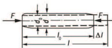
Bild 2.24 Verkürzung infolge einer Druckkraft
