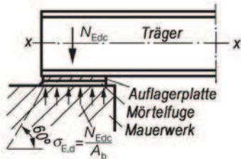
Bild 2.11 Flächenpressung bei einem Trägersauflager
