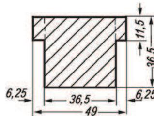
Bild 2.16 Mauerpfeiler mit Anschlägen
