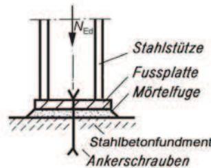
Bild 2.20 Stahlstütze auf Stahlbetonfundament
