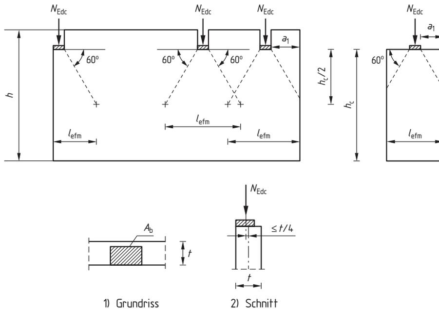
Bild 2.13 Wände unter Teilflächenlasten (EC6-1-1, Bild 6.2)
