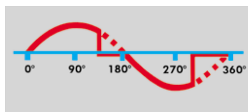
Phasenabschnittsteuerung für Glüh- und Hochvolt-Halogenlampen oder NV-Halogenlampen mit elektronischem Trafo
