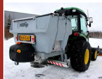
Hilltip Icestriker 600 TR Rafdrifinn kastdreifari fyrir dráttarvél m/öflugum efnisskömmunarbúnaði.
