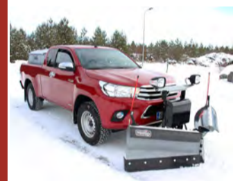
Hilltip Snowstriker VP Fjölplógur fyrir pallbíl, minni vörubíla og jeppa. Fáanlegur í 185–240 cm breidd.
