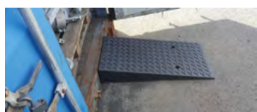
Gúmmirampar fyrir brettatjakk. Stærð: L 100 cm x B 50 cm x H 16 cm. Þyngd: 21 kg. Passa fyrir venjulega vörugáma. Burðargeta 10 tonn Hákonarson ehf. www.hak.is S. 892-4163, hak@hak.is
