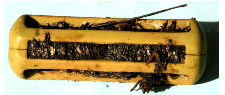
Mynd 2. Dæmi um notaðan vambarsegul úr sláturgrip sem hefur greinilega borgað sig að nota.
