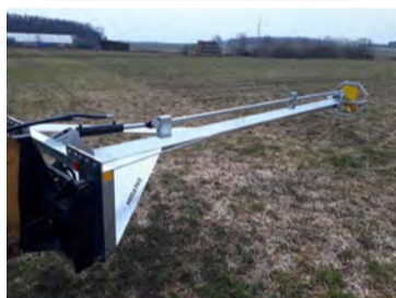
Glussadrifnar haughræur á ámoksturs-tæki eða 3 tengi. Hentar mjög vel fyrir útítanka, útlón og víðar. Lengdir: 4 m, 5 m, 6 m, 6,7 m, 8 m, 9 m. Rótor og skrúfa eru sambyggð, enginn óxull. Mjög léttbyggðar, 9 m löng er aðeins 360 kg. Allar festingar í boði fyrir skotbómulyftara og traktora. Boltaðar festingar sem er fljótlegt að skipta um. Getum einnig skaffað fremsta hlutann án burðarvirkis. Óflugur búnaður á góðu verði frá Póllandi. Hákonarson ehf. hak@hak.is - www.hak.is - S. 892-4163.
