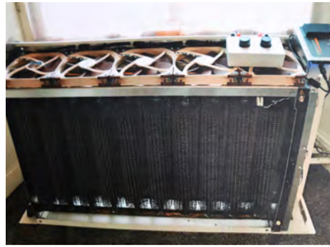
Jón hannaði við annan mann fjölhæfan lághitaofn sem byggir á vatns/lofts-varmaskiptum. Ofninn er með nítján lóðréttum Spirox-varmaskiptum og fimm smáviftum. Hann segir ofninn þann besta sem völ sé á og leitar íslensks framleiðanda.
