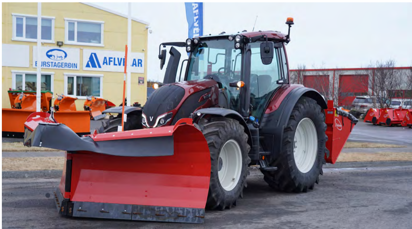
VALTRA N175 með Tokvam fjölplóg VT380 með floti, Tokvam sanddreifara sem getur hlaðið í sig sjálfur með dreifidiski sem dreifir 1 - 8m breidd.
