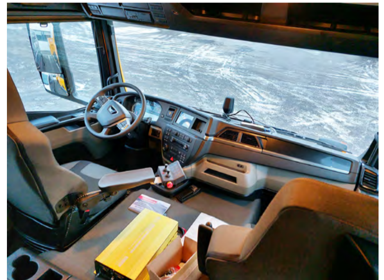
Á milli framsætanna er öflugur spennibreytir fyrir 220w rafmagn.
