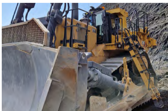
Öflugur landgangur gefur gott aðgengi. Vökvaðmótorar slaka honum niður. Öikumannshúsið er góður staður til að vera á. Mikil hljóðeinangrun gerir aðstöðuna vistlega. Sætið fjáðrar og er stillanlegt.
