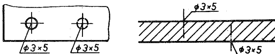
Bilder 13 und 14 Löcher ohne Gewinde, mit Unterscheidung sichtbar – verdeckt bzw. oben- – untenliegend
