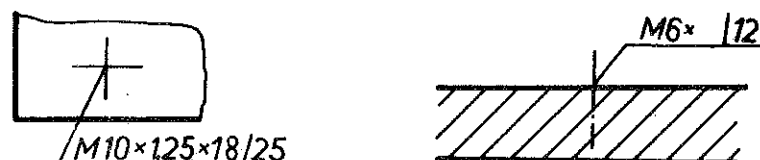
Bilder 17 und 18 Löcher mit metrischem ISO-Grob- bzw. Feingewinde und besonderer Angabe der Kernlochtiefe
