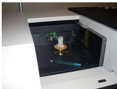
Figura 43 – SkyScan com a amostra de concreto
