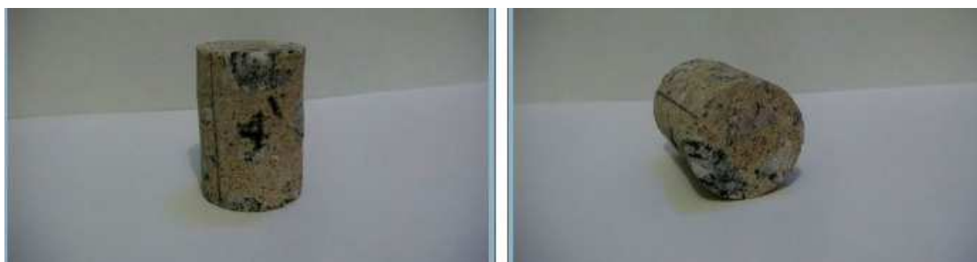
Figura 42 – Corpos de Prova 25mm x 50mm utilizados na microtomografia.
